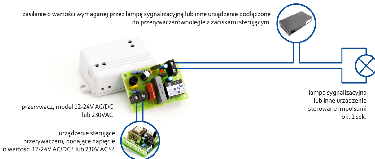
Rys. 2. Schemat podłączenia przerywacza do lampy sygnalizacyjnej z oddzielnym zasilaniem w obwodzie wyjściowym przerywacza.
